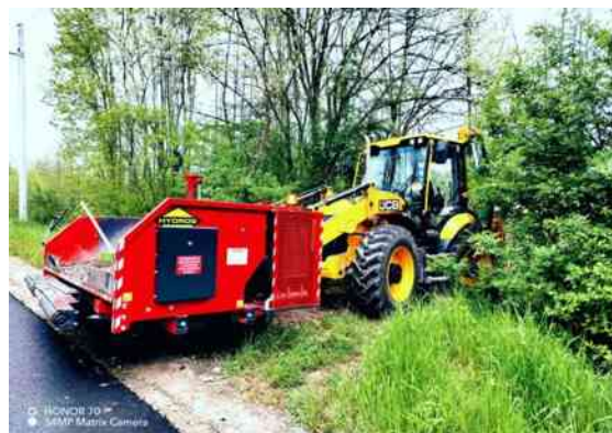
Slika 42. Stroj za polaganje bankina
